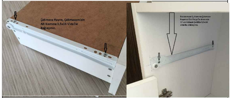
(6.İŞLEM) Çekmecelerimizin alt kısmına rayımızı şekilde görüldüğü gibi bağlıyoruz. Tam karşılığına modülümüzün iç kısmına şekilde görüldüğü gibi 3,5x18 vida ile bağlıyoruz.
